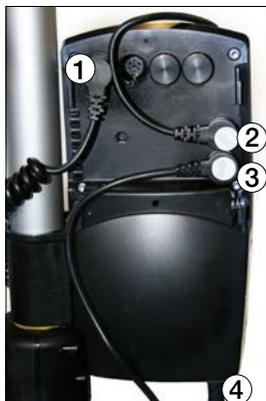
Um die unten stehenden Schaltkreise zu bearbeiten, muss der Deckel der Steuerbox entfernt werden. Dies geschieht zum Beispiel mit Hilfe eines Schraubenziehers – siehe Kennzeichnung auf der Steuerbox.
