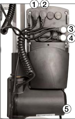
Um die unten stehenden Schaltkreise zu bearbeiten, muss der Deckel der Steuerbox entfernt werden. Dies geschieht zum Beispiel mit Hilfe eines Schraubenziehers – siehe Kennzeichnung auf der Steuerbox.
